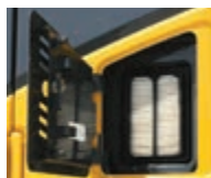
Filtre de climatisation extérieur
