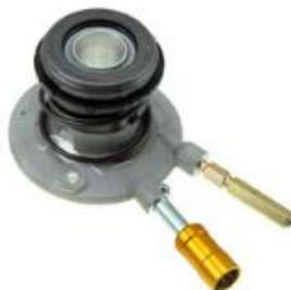
La función del collarín es desacoplar el motor de la caja de transmisión al liberar el plato de presión del disco de embrague. Cuando se pisa el pedal de embrague se presiona el collarín contra el diafragma y como consecuencia el plato de presión se separa del disco de embrague y el collarín gira junto con el plato de presión. Este plato gira a la velocidad del motor por lo que el collarín debe soportar tanto las altas velocidades como las cargas elevadas.
