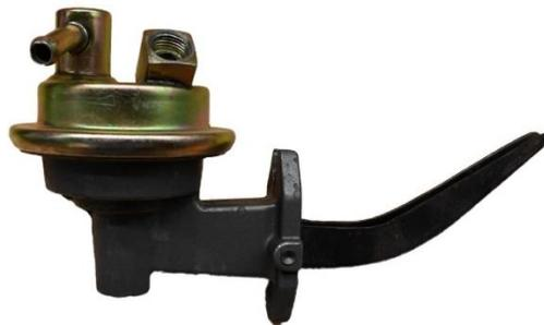
Una bomba de combustible mecánica funciona es accionada por el árbol de levas o por un eje especial, accionado a su vez por el cigüeñal a medida que el eje gira, una leva pasa por debajo de una palanca giratoria y la fuerza sobre un extremo hacia arriba.
