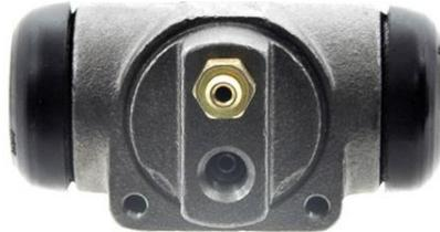
Los cilindros de rueda forman parte del sistema hidráulico de frenado de los automóviles. Su función es convertir la fuerza hidráulica generada por la bomba de freno y transmitida al líquido de freno, en fuerza mecánica empujando las zapatas.
