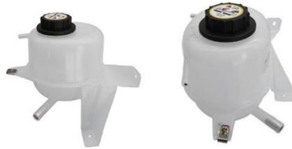
El depósito de anticongelante ayuda al radiador a reponer el refrigerante perdido durante el funcionamiento del vehículo, recuperándolo cuando se enfría si no tuviera este depósito se tendría que estar rellenando el radiador constantemente.
