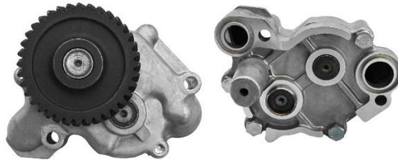
La bomba de aceite regula el volumen y la presión de aceite. Un error común es pensar que la bomba de aceite produce la presión del aceite por sí misma. La bomba de aceite crea solamente el flujo del aceite o caudal. Las restricciones en los pasajes del aceite en el motor producen la presión. Esto es restricción de flujo igual a presión de aceite.
