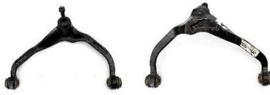
Las horquillas normalmente están fabricadas de acero o aluminio y se asemejan a una letra “y”, la horquilla une comúnmente a la rueda frontal o posterior con el conjunto de cubo de punto único y en el chasis con los dos puntos. Este sistema de suspensión de horquilla evita que la rueda gire hacia un lado y mantiene un seguimiento de neumático recto.
