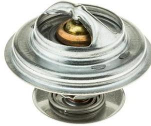
Este dispositivo es una válvula metálica con un resorte que se encarga de regular el flujo de refrigerante o agua al radiador para mantener la temperatura óptima del auto, es decir evita que estos líquidos fluyan dentro del motor hasta que estos no hayan alcanzado su temperatura de funcionamiento de acuerdo con las especificaciones del fabricante.
