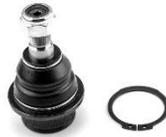
Una de las partes más importantes de la suspensión es las rotulas, permite el movimiento de la dirección y es la unión entre el porta mango y los brazos de control, es una pieza de mucho desgaste por el todo el movimiento que tiene por lo tanto deber ser resistente. Su tarea es guiar al soporte de rueda y la rueda, para permitir la flexión del muelle de la rueda y permitir el movimiento de dirección del eje delantero. De acuerdo a su función hay dos tipos de rotulas: de carga y seguidora.
