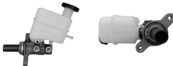
El cilindro maestro es un dispositivo de control hidráulico que convierte la energía física del pie de un conductor, en la presión hidráulica para accionar otros dispositivos, como los cilindros de rueda y caliper. El depósito este hecho principalmente de resina sintética, mientras que los cilindros están hechos de hierro fundido o de una aleación de aluminio.
