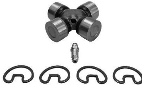
Elemento intermedio de una junta cardan, comprendido entre las dos horquillas. Las horquillas de una junta cardan se encuentran en planos perpendiculares entre sí y deben poder moverse angularmente una respecto a la otra, esto se consigue mediante un elemento central que es la cruceta la cual tiene cuatro cabezas.
