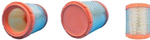
Es un dispositivo que elimina partículas sólidas, su función es filtrar el aire que entra al motor, limpiándolo de impurezas, polvo y mosquitos. Si no existiese este filtro todas las partículas de polvo, aire y suciedad entrarían a los cilindros del motor, aumentando el consumo de gasolina y contaminando el aceite.
