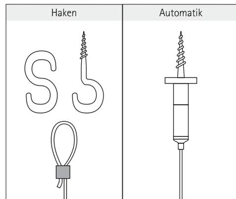
Die Beschriftung erfolgt unmittelbar auf die Beschriftungsfläche durch selbstklebende Folienbuchstaben, Digitaldruck oder Brandschutz- / Fluchtwegsymbole. Die Deckenbefestigung erfolgt wahlweise mittels herkömmlichen Haken oder der Deckenautomatik. Die Automatik lässt ein nachträgliches Justieren zu, so dass Unebenheiten sowie kleine Unterschiede in der Seillänge mühelos ausgeglichen werden können.
