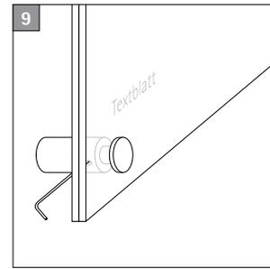
Mit der seitlichen Montageschraube wird der Bolzen in der Buchse arretiert und die Glasscheiben zusammengepresst.
