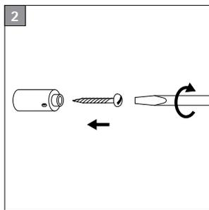
Nach dem Setzen des Dübels\* wird der Abstandhalter durch die vordere Öffnung zunächst leicht arretiert.
