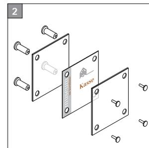
Abstandhalter am Schild vormontieren (Abb. 1 bis 3) und als Gesamtes nach Aktivierung der Klebeflächen fest auf den Untergrund aufpressen (Abb. 4). Der Untergrund muss eben, staub- und fettfrei sein.
