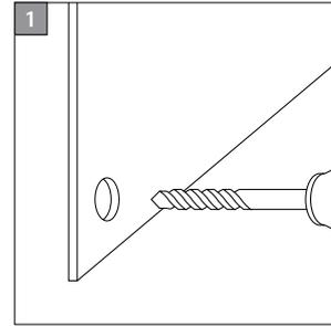
Das Glas wird als Montageschablone verwendet. Nach dem Anzeichnen der Bohrlöcher das Glas von der Wand nehmen und die Löcher möglichst exakt in die Wand bohren.
