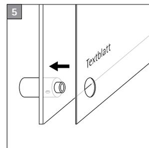
Nach dem Aufbringen der ersten Scheibe den Beschriftungsträger einlegen, so dass die vorgestanzten Löcher über dem Hals der einzelnen Buchsen liegen.
