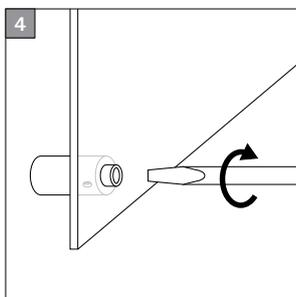
Die rückseitige Glasscheibe aufsetzen. Mit der Glasscheibe die richtige Position der Abstandhalter justieren. Anschließend die Wandschrauben\* richtig anziehen.
