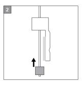
Am Seilende eine Pressöse aufbringen und Stahlseil durch das Klemmstück ziehen.
