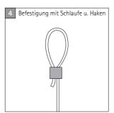
Schildanlage mittels Automatik oder Haken an Decke befestigen. Für abgehängte Decken empfehlen wir die Verwendung einer Schlaufe. Diese wird nach dem Ablängen des Stahlseils ebenfalls mit einer Pressöse geschlossen und an einem handelsüblichen Haken aufgehängt.
