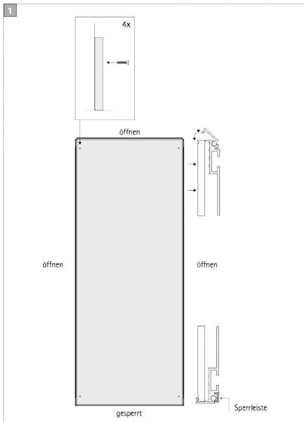
Drei Klappprofile öffnen (eine kurze Seite lässt sich auf Grund des Sperrprofils nicht öffnen) und die transparente Abdeckung entnehmen.
