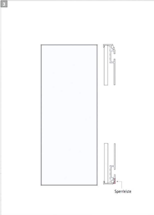
Beschriftungseinlage(n) einbringen. Transparente Abdeckung mit entspiegelter Seite (mit V-Fuge) nach vorne einlegen und Klappprofile schließen.
