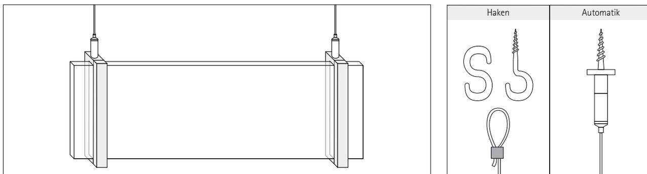
Die Deckenbefestigung erfolgt wahlweise mittels herkömmlichen Haken oder der Deckenautomatik. Die Automatik lässt ein nachträgliches Justieren zu, so dass Unebenheiten sowie kleine Unterschiede in der Seillänge mühelos ausgeglichen werden können.
