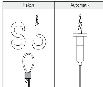
Die Deckenbefestigung erfolgt wahlweise mittels herkömmlichen Haken oder der Deckenautomatik. Die Automatik lässt ein nachträgliches Justieren zu, so dass Unebenheiten sowie kleine Unterschiede in der Seillänge mühelos ausgeglichen werden können.
