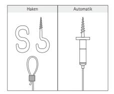
Die Deckenbefestigung erfolgt wahlweise mittels herkömmlichen Haken oder der Deckenautomatik. Die Automatik lässt ein nachträgliches Justieren zu, so dass Unebenheiten sowie kleine Unterschiede in der Seillänge mühelos ausgeglichen werden können.
