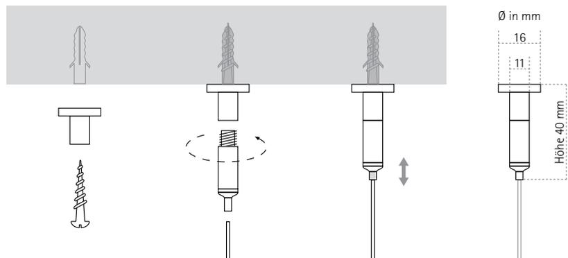
Tragkraft: 25 kg pro Automatik, bitte auf ausreichende Dimensionierung der Schrauben und Dübel achten.
