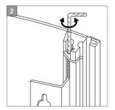
Nach dem Einhängen (s. Punkt 1) in die Schrauben wird der Wegweiser mit der oben liegenden Vorrichtung und unter Zuhilfenahme eines Imbusschlüssels justiert.
