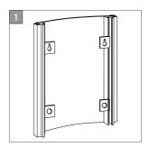
Die Montage erfolgt mit zwei Schrauben, an denen der Wegweiser durch die Schlüssellochbohrungen aufgehängt wird. Nach dem Justieren (s. Punkt 2) werden die unten liegenden Montageflächen mit der Wand verklebt um eine unbefugte Entnahme zu verhindern.
