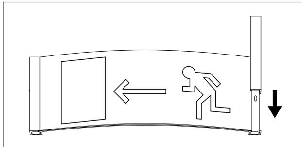
Versteckte Montage: Die Lochbohrungen werden durch die Abschlussleisten verdeckt.
