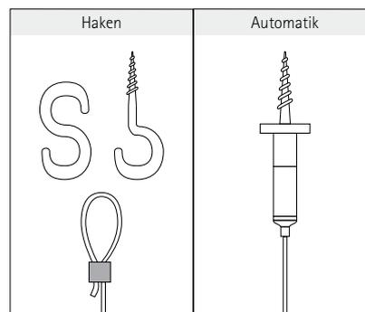
Die Beschriftung erfolgt unmittelbar auf die Beschriftungsfläche durch selbstklebende Folienbuchstaben, Digitaldruck oder Brandschutz- / Fluchtsymbole. Die Deckenbefestigung erfolgt wahlweise mittels herkömmlichen Haken oder der Deckenautomatik. Die Automatik lässt ein nachträgliches Justieren zu, so dass Unebenheiten sowie kleine Unterschiede in der Seillänge mühelos ausgeglichen werden können.
