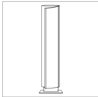
Die Beschriftung kann wahlweise mit Plottbuchstaben, Papiereinlage oder durch Digitaldruck erfolgen. Die Tür des Innenwegweisers durch Anheben des seitlichen Schiebers öffnen, nachdem die Kunststoffhaube nach außen gedreht wurde. Die Beschriftung kann nun eingebracht werden.
