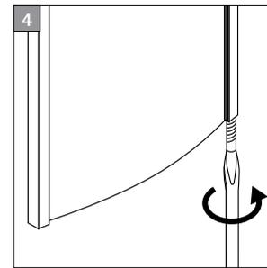
Nach dem Arretieren des Schildes durch die Sicherungsschraube ist die Montage abgeschlossen.
