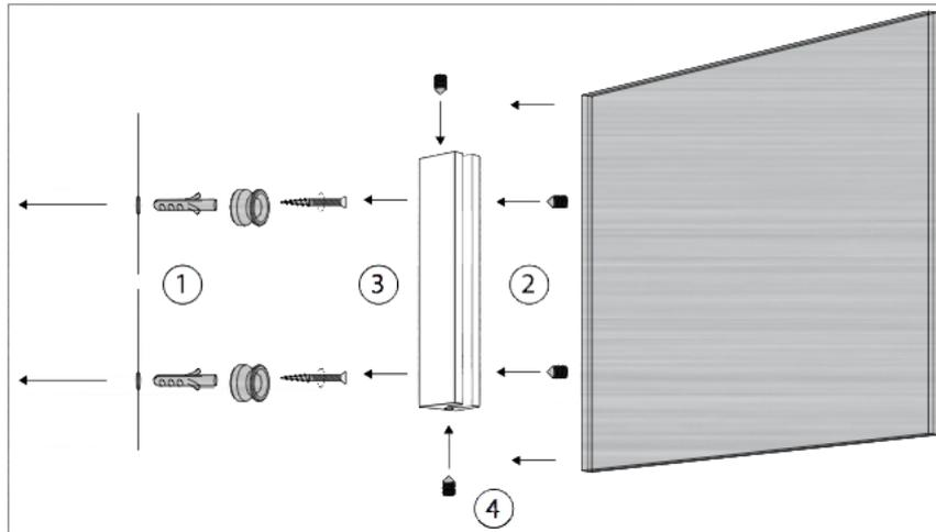
Das Fahnschild besteht aus zwei ESG-Scheiben und einem Fahnenadapter.
