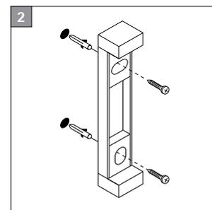
Nach dem Setzen der Dübel\* die Adapter-Basis (C) mit zwei Schrauben\* in der gewünschten Position und Ausrichtung anbringen.
