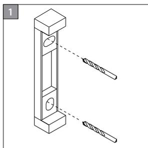
Die Adapter-Basis (C) wird als Montageschablone verwendet. Nach dem Anzeichnen der Bohrlöcher den Adapter von der Wand nehmen und die Löcher möglichst exakt in die Wand bohren.
