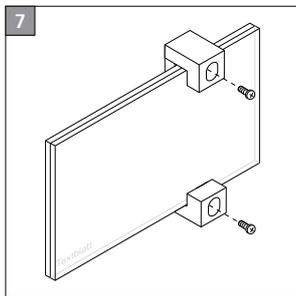
Glasscheibe ausrichten und mit den Schrauben (G) fixieren.
