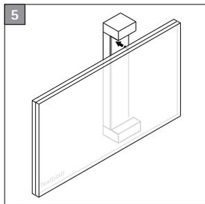
... und an der gewünschten Position in die Aussparung der Adapter-Basis (C) legen. Die Glasscheiben sind horizontal frei in der Halterung (Adapter) positionierbar.
