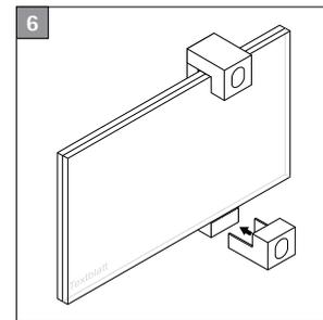
Die Glashalter (E) auf die Adapter-Basis (C) stecken um die Glasscheiben am Adapter zu befestigen.
