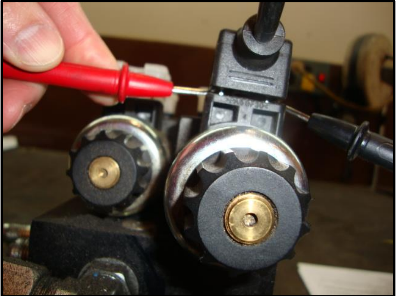
Fig. 8-4 Checking Din Plug Voltage
