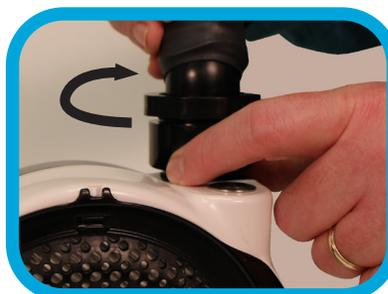
a. Vergewissern Sie sich, dass die Gummidichtung im Anschluss der Luftversorgung an der Turbogebläseeinheit eingesetzt ist.
