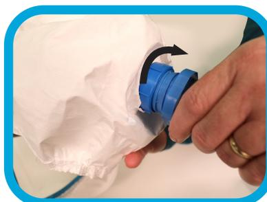
c. Stellen Sie sicher, dass weder der Atemschlauch noch der Haubenanschluss blockiert sind.
