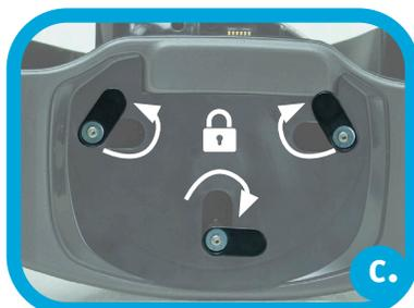
c. Drehen Sie die Hebelverschlüsse, bis sie wie abgebildet ausgerichtet sind. Wiederholen Sie die Schritte in umgekehrter Reihenfolge, um die Turbogebläseeinheit vom Gurt abzunehmen.
