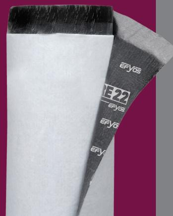
**VELAPHONE est une membrane acoustique composée de feutre de polyester et d'un film pare-vapeur (pellicule noire). Elle est spécialement conçue pour être installée principalement sur les structures de bois sous les chapes de béton autonivelant de 38 mm (1 ½ po) d'épaisseur.**
