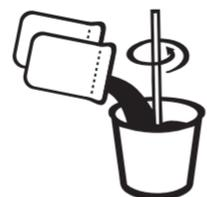
**1** Ajouter d'abord de l'eau, suivi du coulis sec et mélanger jusqu'à consistance lisse et uniforme. Add water first, followed by powder, then mix until smooth and uniform.
