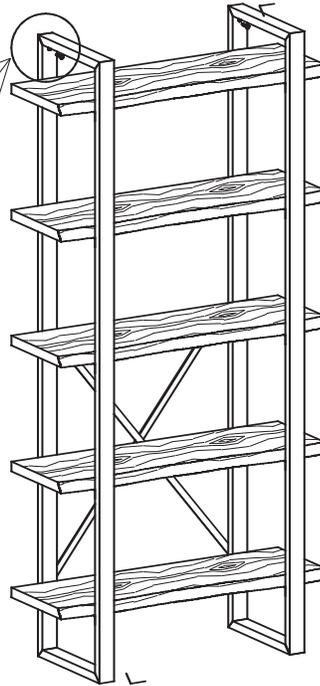
Retirez le capuchon de plastique et fixez l'étagère au mur à l'aide de vis. (Utilisez la cheville d'ancrage adaptée au type de mur. Percez des trous à l'aide d'une mèche.)
