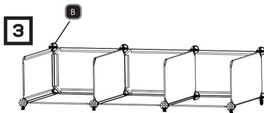
**3** Insérez 3 ou 4 connecteurs B du côté arrière.
