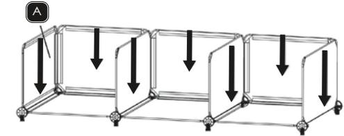
Insérez 5 ou 7 panneaux A de côté et à l'arrière.
