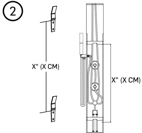
**2** Mesurez la distance entre les deux supports derrière la colonne. Marquez ensuite ces mesures à l'emplacement choisi pour l'installation sur le mur.
