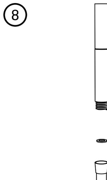
Posez la rondelle de caoutchouc. Fixez la douchette à main au tuyau flexible.
