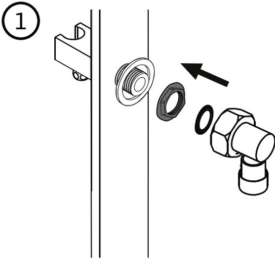
**1** Posez le raccord pour la douchette à main et joignez-y le tube en PVC pour le raccordement.
