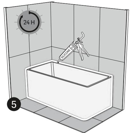
Placez le bain à l'endroit exact où il doit être installé en alignant parfaitement les tuyaux de renvoi (au sol et dans le bain). Appliquez le silicone aux endroits indiqués. **ATTENDEZ 24 HEURES AVANT D'UTILISER LE BAIN** afin de permettre au silicone de sécher.
