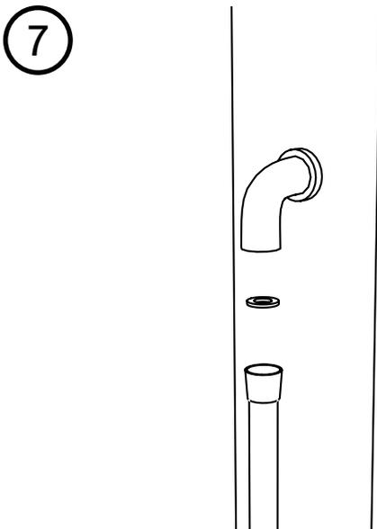
Raccordez le tuyau flexible de douchette à main au cadre de la colonne. Posez la rondelle à grille pour empêcher les débris de pénétrer dans le tuyau.
