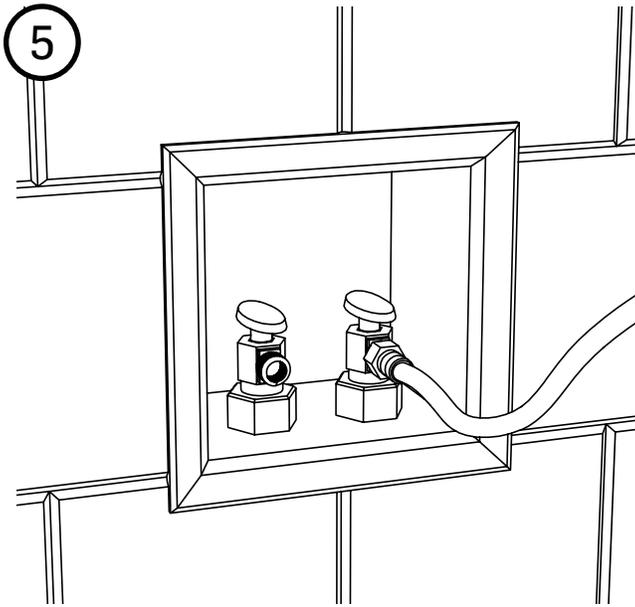
Recouvrez le filetage des robinets de ruban d'étanchéité avant de raccorder les tuyaux flexibles d'alimentation d'eau froide et d'eau chaude aux robinets. Ouvrez les robinets et vérifiez que tous les raccords ne présentent pas de fuite.
