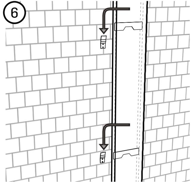
Accrochez la colonne de douche au mur pour terminer l'installation. Vérifiez qu'elle est bien positionnée. Appliquez le scellant de silicone du côté gauche et du côté droit de la colonne de douche.
