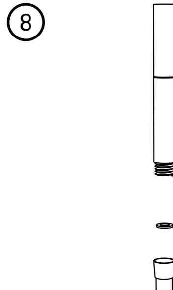
Posez la rondelle de caoutchouc. Fixez la douchette à main au tuyau flexible.
