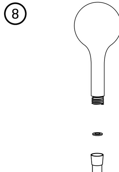
Posez la rondelle de caoutchouc. Fixez la douchette à main au tuyau flexible.
