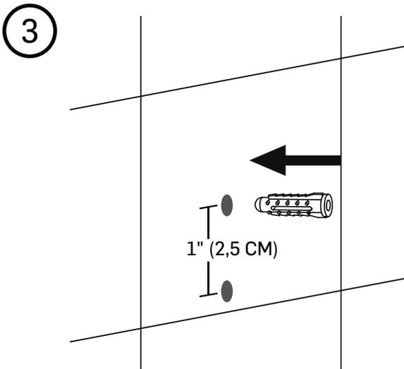
**3** Percez les trous lentement dans la céramique à l'aide d'une perceuse munie d'une mèche à céramique. Ne percez pas dans un tuyau ou un câble dans le mur. Insérez les ancrages dans le mur.
