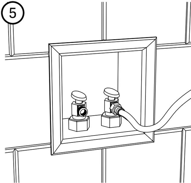
Recouvrez le filetage des robinets de ruban d'étanchéité avant de raccorder les tuyaux flexibles d'alimentation d'eau froide et d'eau chaude aux robinets. Ouvrez les robinets et vérifiez que tous les raccords ne fuient pas.
