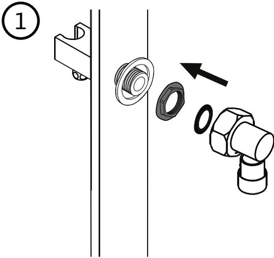
**1** Posez le raccord pour la douche à main et joignez-y le tube en PVC pour le raccordement.
