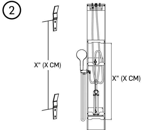
**2** Mesurez la distance entre les deux supports derrière la colonne. Marquez ensuite ces mesures à l'emplacement choisi pour l'installation sur le mur.
