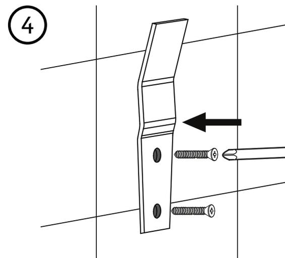
**4** Fixez les supports de fixation au mur à l'aide des vis.
