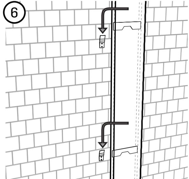
Accrochez la colonne de douche au mur pour terminer l'installation. Vérifiez qu'elle est bien positionnée. Appliquez le silicone à gauche et à droite de la colonne de douche.
