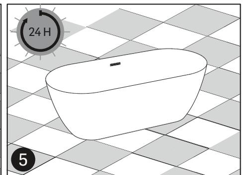
Placez la baignoire à l'endroit exact où elle doit être installée en alignant parfaitement les tuyaux de renvoi (au sol et dans la baignoire). Tracez le contour de la baignoire au sol. Retirez la baignoire et appliquez un boudin de silicone ou d'adhésif sur la marque que vous avez faite. Tenez compte de l'espace créé par la distance des pattes. Remettez la baignoire à sa place et permettez au silicone de durcir en attendant 24 heures avant de faire les raccords.
