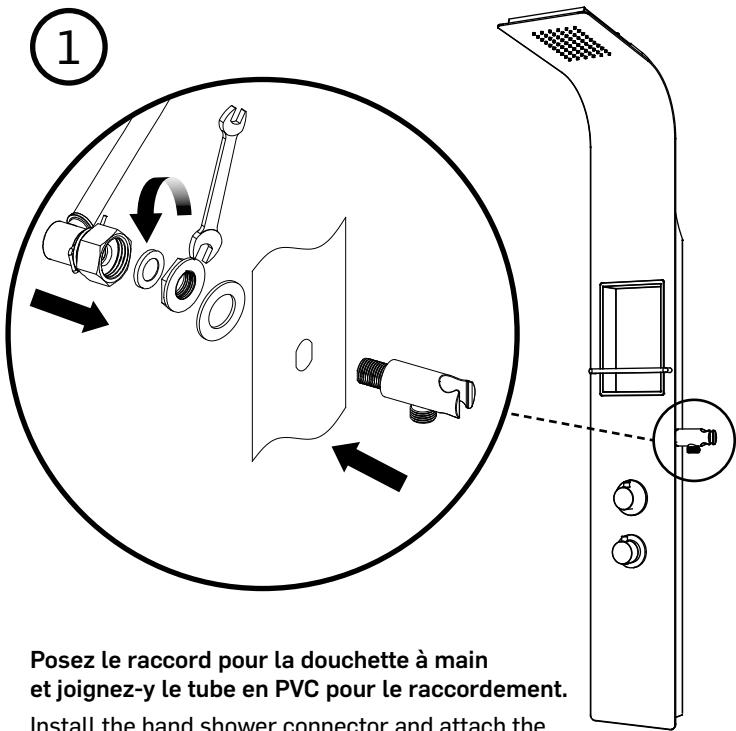
Posez le raccord pour la douchette à main et joignez-y le tube en PVC pour le raccordement.
