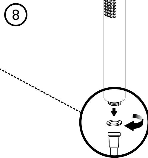
Posez la rondelle de caoutchouc. Fixez la douchette à main au tuyau flexible.
