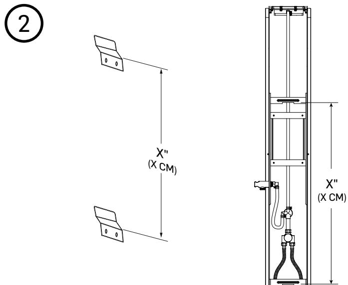
Mesurez la distance entre les deux supports derrière la colonne. Marquez ensuite ces mesures à l'emplacement choisi pour l'installation sur le mur.
