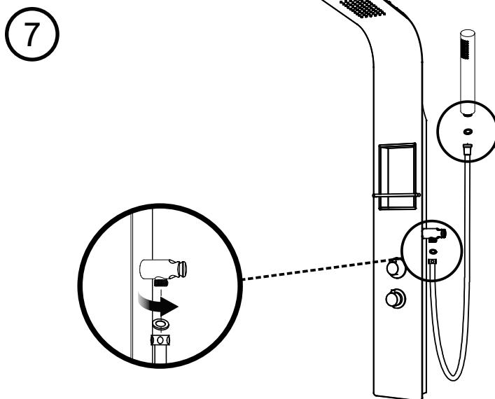
Raccordez le tuyau flexible de douchette à main au cadre de la colonne. Posez la rondelle à grille pour empêcher les débris de pénétrer dans le tuyau.
