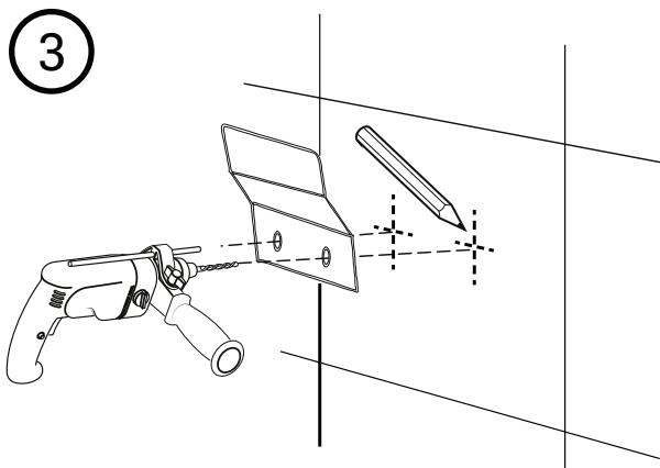
Percez les trous lentement dans la céramique à l'aide d'une perceuse munie d'une mèche à céramique. Ne percez pas dans un tuyau ou un câble dans le mur. Insérez les ancrages dans le mur.
