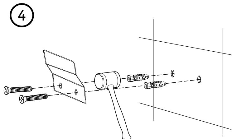
Fixez les supports de fixation au mur à l'aide des vis.
