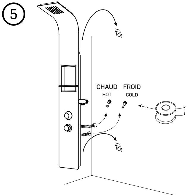
Recouvrez le filetage des robinets de ruban d'étanchéité avant de raccorder les tuyaux flexibles d'alimentation d'eau froide et d'eau chaude aux robinets. Ouvrez les robinets et vérifiez que tous les raccords ne fuient pas.
