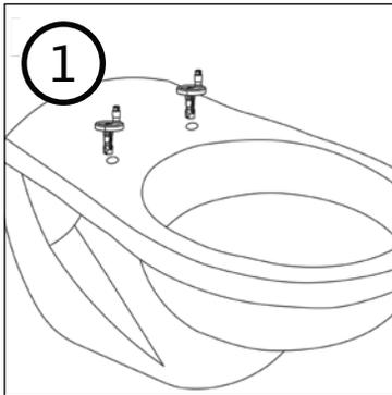
Insérez les ancrages dans les orifices de la cuvette.
