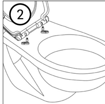
Poussez les ouvertures du siège sur les ancrages alors que le siège et le couvercle sont ouverts et faites le réglage pour que le siège s'ajuste à la toilette. Retirez le siège en le tirant.
