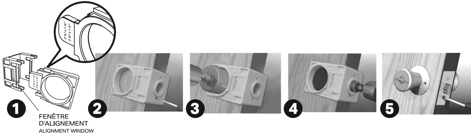
Sert à installer des serrures sur des portes en bois et en acier de 1  $\frac{3}{8}$ " (35 MM) et 1  $\frac{3}{4}$ " (44 MM) d'épaisseur et dont le recul de montage est de 2  $\frac{3}{8}$ " (60 MM) ou 2  $\frac{3}{4}$ " (70 MM) (distance entre le bord de la porte et le centre de la serrure).
