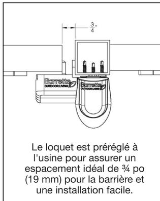
Les supports sont prémontés et prêts à être installés pour une barrière à ouverture à gauche.
