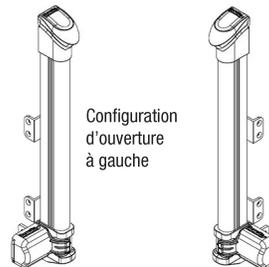
**2** Faire glisser les supports A et B hors du loquet, les retourner dans la direction opposée et les remettre en place.
