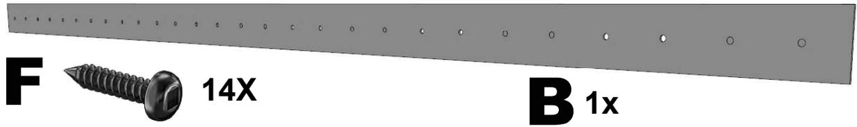
**OPTIONNEL : Percer les marques de poinçon sur l'une des pièces "B".**
