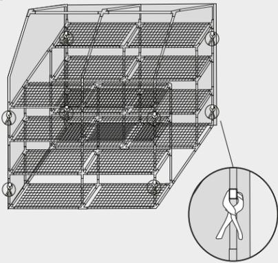
Note : Lorsque la section avant de la housse est ouverte, vous pouvez la rouler et la maintenir en place à l'aide des attaches fournies.
