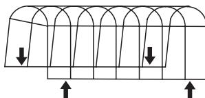
Placer les ancrages tel qu'indiqué sur le schéma. Le nombre d'ancrage dépend de la longueur de l'abri.
