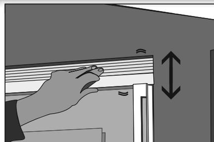
Installer les cache-vis sur le boîtier de la moustiquaire rétractable.
