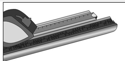
Placer le rail sur le seuil. **L'encoche en «L» sur le rail servira à enjamber le cadrage extérieur.**
