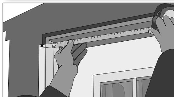
L'encoche en «L» sur le rail du haut doit venir s'appuyer sur le boîtier de la moustiquaire rétractable. En gardant l'encoche en «L» du côté du boîtier de la moustiquaire rétractable, vous allez devoir couper du côté opposé. Assurez-vous de prendre votre mesure sur la partie arrondie de votre rail. Une fois vos mesures prises, couper votre rail en utilisant une scie à métaux.
