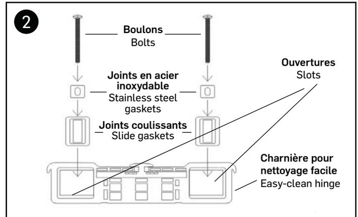
Glissez les joints coulissants dans les ouvertures et ajoutez les joints en acier inoxydable. Vissez-les en place.
