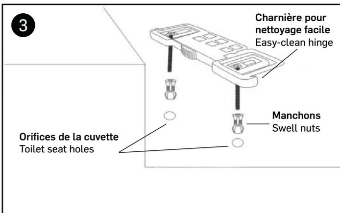
Mettez les manchons dans les orifices de la cuvette, puis insérez les boulons dans ceux-ci et vissez bien.
