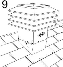
Installer la tête du ventilateur sur le solin de pente, mettre au niveau et fixer avec les vis fournies, dans toutes les perforations. Assurez-vous que le premier déflecteur du bas soit à 6po au-dessus du faîte (Modèle 301 démontré)
