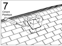
Ré-installer les bardeaux autour du solin afin de compléter l'installation. Ajouter un joint de ciment plastique autour du solin.
