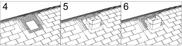
Ré-installer le bardeau au bas de l'ouverture et appliquer une couche de bitume pour compléter le périmètre, tel qu'illustré.
