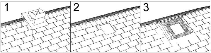
Placer le solin sur le toit à l'endroit désiré. Assurez-vous d'être entre les poutres. Tracer une ligne sur la toiture par l'intérieur du solin. L'ouverture doit commencer à environ 150-200 mm du faîte.
