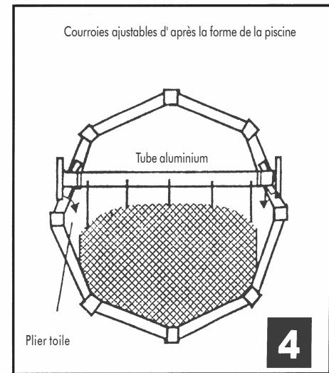
Lorsque vous installez les courroies à la toile solaire, elles doivent être à égale distance entre elles. La longueur des courroies doit être ajustée en fonction de la forme de la piscine.
