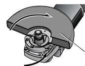
5. Pour retirer le capot protecteur, dégager le verrou du capot, tourner le capot de sorte que les flèches s'alignent puis tirer sur celui-ci.
