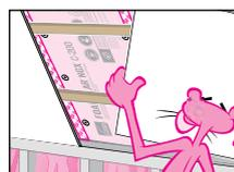
**4. SUPPORT DES PLAQUES DE PLÂTRE** Posez des fourrures en bois perpendiculairement à la structure du plafond avec des vis tous les 305 mm (12 po) centre-à-centre.
