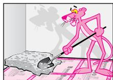
**3. POSE DU BÉTON** Versez le béton directement sur les panneaux jusqu'à l'obtention de l'épaisseur désirée.
