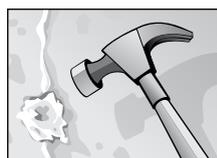
**1. PRÉPARATION DES MURS** Assurez-vous que le mur de béton soit aussi plat que possible; utilisez un marteau pour niveler la surface.
