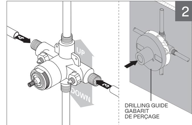
\*We insist on using copper pipe to connect the valve to the spout and to the shower head. PEX pipe adaptors can cause flow restriction, thus creating a backflow to the showerhead. Nous insistons sur l'utilisation d'un tuyau de cuivre pour raccorder la valve au bec de bain et à la pomme de douche. Les adaptateurs de tuyau PEX peuvent causer une restriction de débit et un retour d'eau à la douche.
