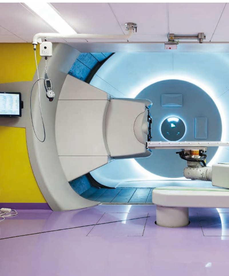
▲ En accelerator ger protonerna energi och hastighet innan de skjuts in på exakt rätt ställe i patienten.
