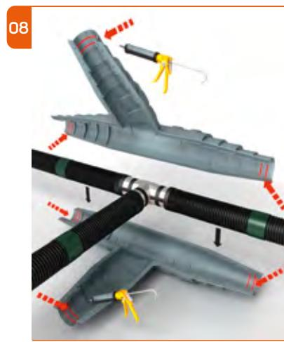
Påfør to linjer med den medfølgende tetningsmassen med en minimumstykkelse på 5 mm og en bredde på minimum 4 mm på alle T-kappens ender.
