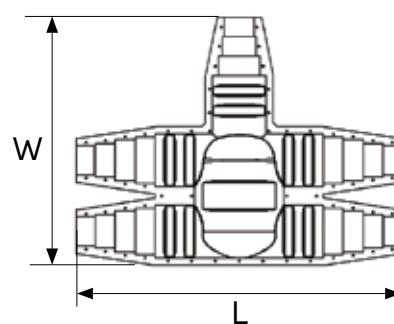
For å unngå innitrenging av (grunn-)vann, foreskriver Terrendis bruk av krympehettar for å forsegla endene til det flerlagstrukturerte rørsystemet.
