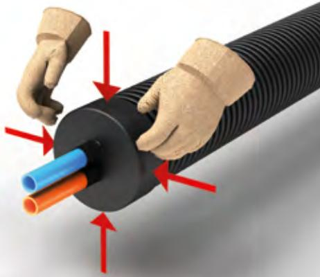
Bruk vernehansker og press krympedekselet på innerrør og mantelrørrene.
