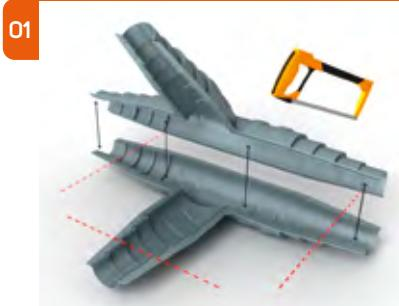
Skjær T-kappene i isolasjonssettet i henhold til ønsket mantelrørdiameter. Hver fordypning tilsvarer en spesifikk mantelrørdiameter. Skallet med rillen brukes som det nederste skallet.
