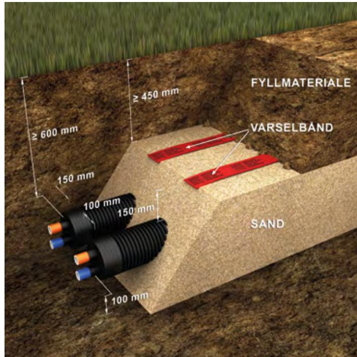
Terrendis® hyperfleksible preisolerte rør krever en minimumsdekning på 600 mm i installasjoner der de utsettes for stress fra trafikkbelastning. Fyllmaterialet må komprimeres forsiktig lag for lag.
