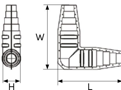
For å unngå innitrenging av (grunn-)vann, foreskriver Terrendis bruk av krympehettet for å forsegle endene til det flerlagstrukturerte rørsystemet.
