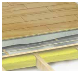
Sponplate 22mm med spor og varmfordelingsplater
