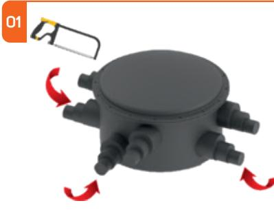
Kutt endeåpningene til UICen i henhold til ønsket mantelrørdiameter. Kutt ende Ø 120 mm for mantel 110 mm, Ø 170 mm for mantel 140/160 og Ø 235 mm for mantel 75/90/200/225 mm.
