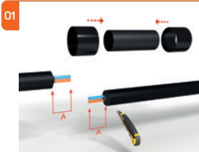
Fjern mantelrøret og isolasjonslagene forsiktig uten å skade innerrørene. Lengden på innerrør er merket med A. Lengden er avhengig av diameteren til bærerørene.
