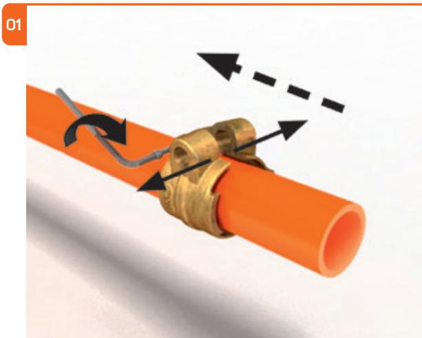
Kutt rett over innerrøret, med en PE-X saks og ta av grader. Utvid klemringen med en sekskantnøkkel. Skyv over klemringen som vist, så begge klemringens kjever peker mot rørenden.
