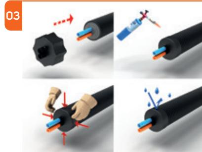
Skyv krympehetten på mantelrøret. Varm opp krympehetten både på enden av innerrør og mantelrørene. Bruk vernehansker og press krympehetten på medium- og mantelrørene.
