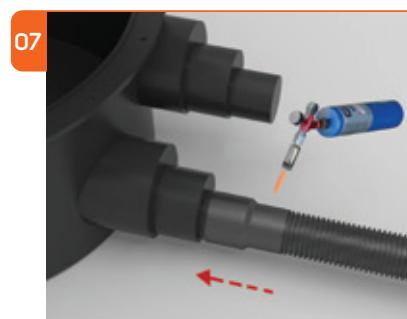
Skyv den tidligere monterte krympemansjetten over det preisolerte røret og UICens endeåpninger. Bruk vernehansker og varm krympemansjetten forsiktig opp, og press mansjetten på mantelrøret og på UICens endeåpninger.
