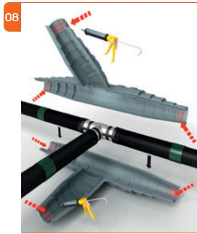
Påfør to linjer med den medfølgende tetningsmassen med en minimumstykke på 5 mm og en bredde på minimum 4 mm på alle T-kappens ender.
