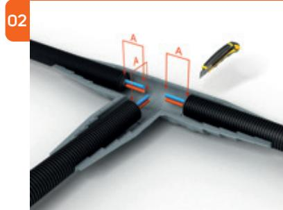
Fjern mantelrøret og isolasjonslagene forsiktig uten å skade innerrørene. Innerrørenes lengde er merket med A. Lengden er avhengig av diameteren til bærerørene.
