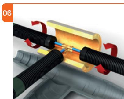
Installer den største steinullen på hovedrøret med selvklebende tape (ikke inkludert). Den minste steinullen festes rundt grenrøret.
