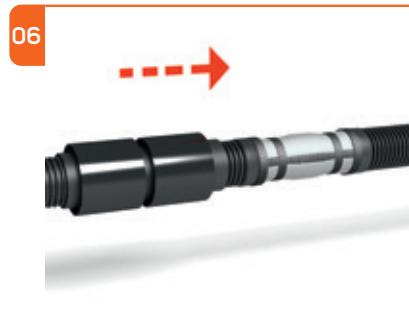
Skyv over krympemuffen til begge ender av det prisolerete røret er dekket. Skyv deretter over begge krympemansjettene, så hver av dem dekker halve det rette dekkørret og halve mantelrøret.
