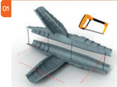
Skjær T-kappene i isolasjonssettet i henhold til ønsket mantelrørdiameter. Hver fordypning tilsvarer en spesifikk mantelrørdiameter. Skallet med rillen brukes som det nederste skallet.
