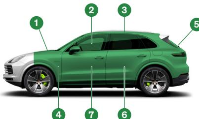
Os materiais balísticos usados foram selecionados com base no nível III-A de proteção balística.
