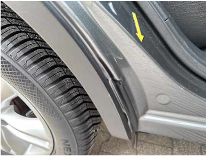
Seitenteil hinten rechts (Verformung)
