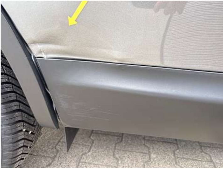
Türe hinten rechts (Verformung, Lackschaden)
