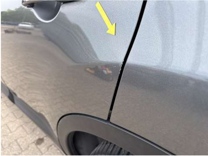
Türe hinten links (Lackschaden)
