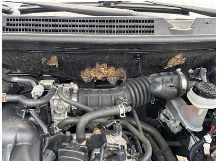
Motorhaube (Anderer Schaden): Dämmung
