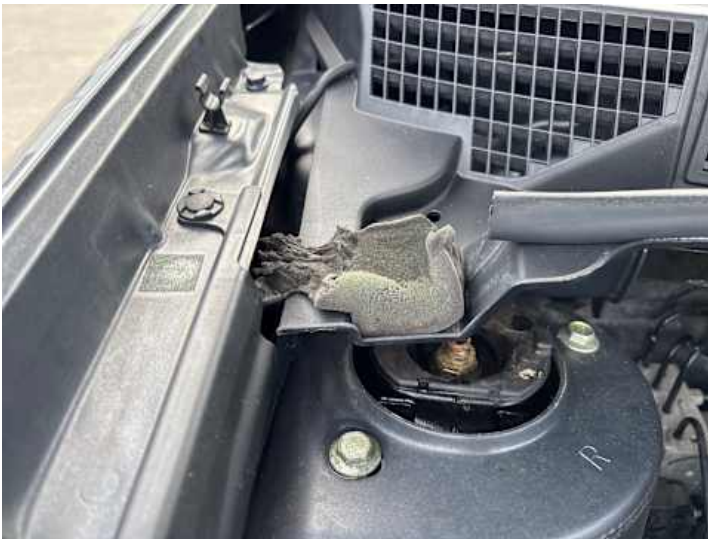
Motorhaube (Anderer Schaden): Dämmung
