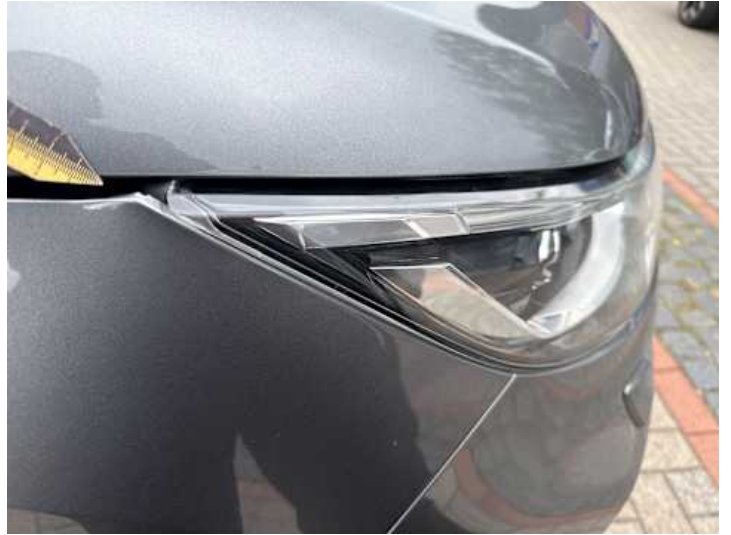
Scheinwerfer (rechts) (Riss/Bruch)
