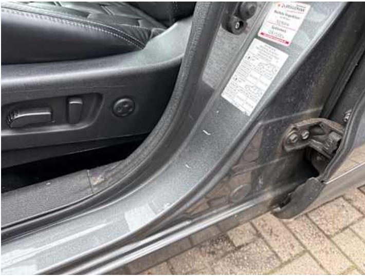
Schweller links (Kratzer, Delle)
